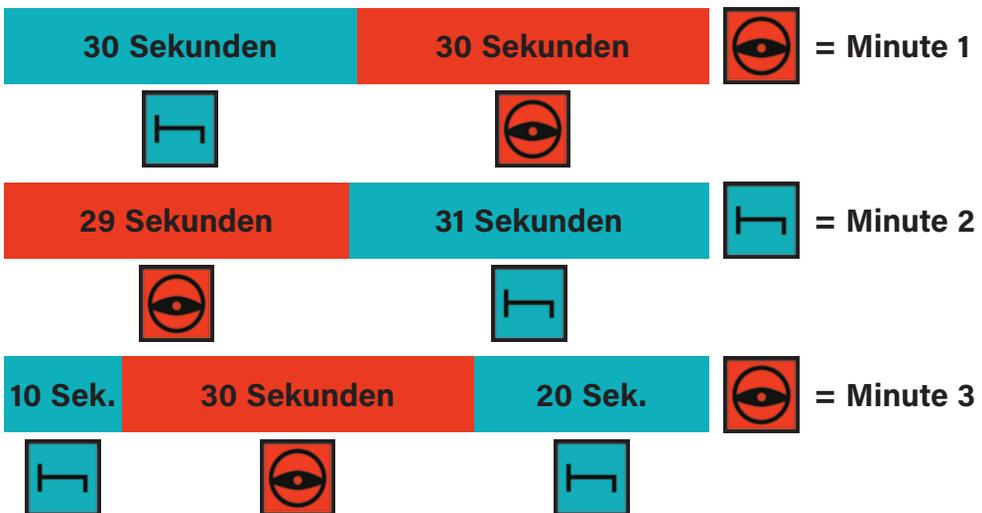
Betrachten wir nun alle 3 Möglichkeiten im Zusammenhang von 3 Minuten, dann ist die Aufzeichnung durchgängig »Lenkzeit«, da die mittlere Minute von 2 Lenkzeitminuten umschlossen wird.
